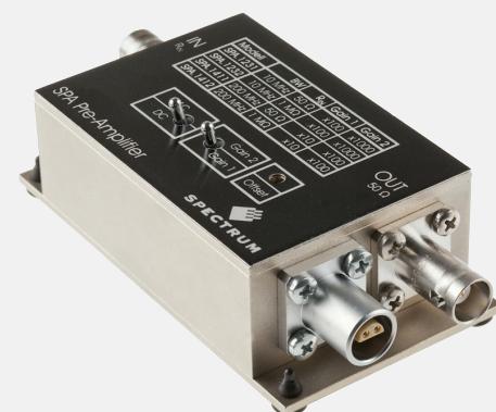
Bild 3. Die Verstärker der SPA-Baureihe eignen sich ideal, um Niederpegel-Detektorsignale vor der Einspeisung in einen Digitizer zu verstärken.
