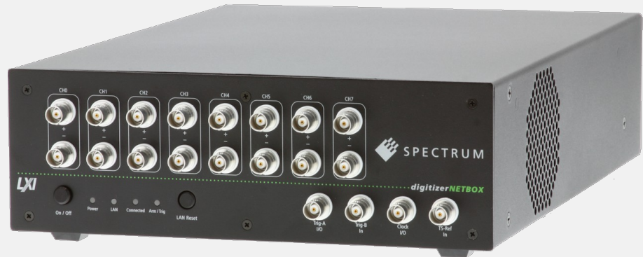
Bild 1: Eine von 59 erhältlichen digitizerNETBOX-Konfigurationen, die DN2.465-08 mit 8 Kanälen, 3 MS/s und 16-Bit-Digitizer mit Single-Ended und True-Differential-Eingängen.
