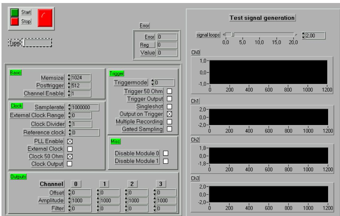
Im Demo VI TestMI61 werden die Funktionen des Treibers als Beispiel genutzt, um eine einfache interaktive Oberfläche für die Ausgabe von Daten zur Verfügung zu stellen.
