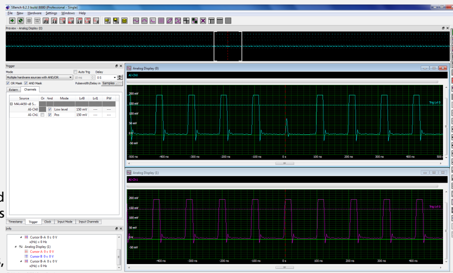
Abbildung 5: Ein weiteres Beispiel für die Verwendung der AND-Triggerfunktion bei invertiertem Logikelement (Low-Pegelmodus auf Ch0). Der Trigger erfolgt, wenn ein ausbleibender Impuls auf Kanal Ch0 im Abgleich mit der Impulsfolge auf Ch1 festgestellt wird.
