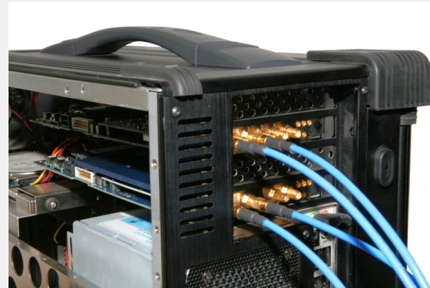
Bild 1: Ein typisches modulares Stimulus-Response-Testsystem aus einem 14-Bit-Digitizer vom Typ Spectrum M4i.4451-x8 mit 500 MS/s und 250 MHz Bandbreite sowie einem 16-Bit-AWG vom Typ M4i.6631-x8 mit 1,25 GS/s und 400 MHz Bandbreite, die in einem tragbaren Computer untergebracht sind.
