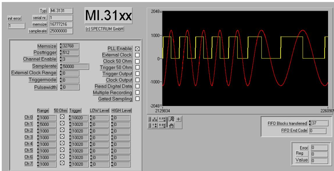
Die Daten werden im Rohformat ausgelesen und nur für die Anzeige neu dimensioniert. Es erfolgt aus Performancegründen keine Umrechnung in Spannungswerte, wie sie im Oszilloskop Beispiel vorgenommen wird.
