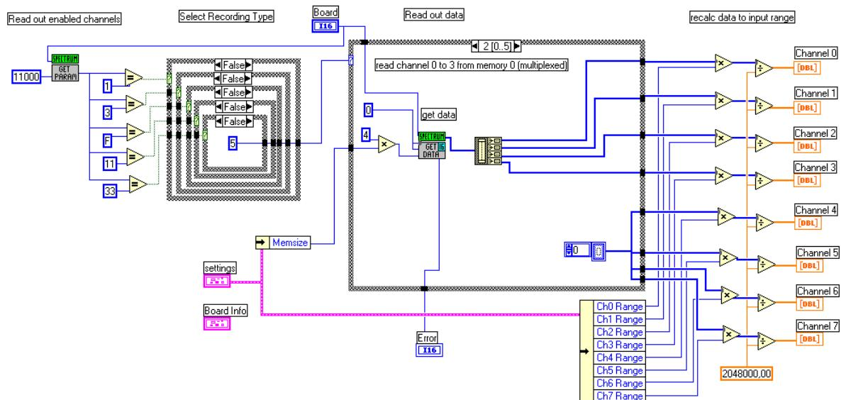
Liest Daten aus dem Speicher der MI.31xx. Die Länge der Datensätze entspricht der vorher programmierten Speichertiefe. Die Daten werden in ein array von [DBL] Werten umgewandelt, die den gemessenen Spannungswerten entsprechen. Der eingestellte Eingangsbereich wird für die Umrechnung der Daten benutzt.
